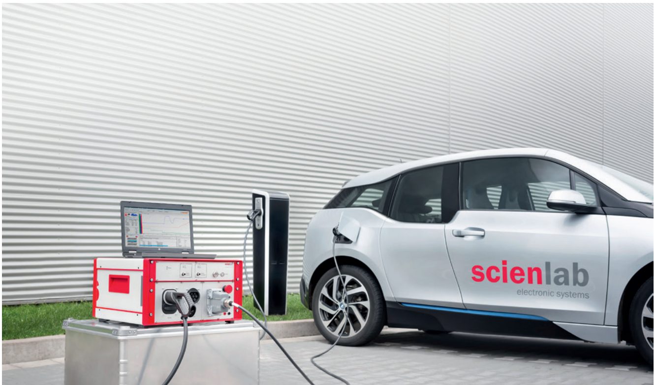
Das ChargingDiscoverySystem im Feldeinsatz als Man-in-the-Middle
