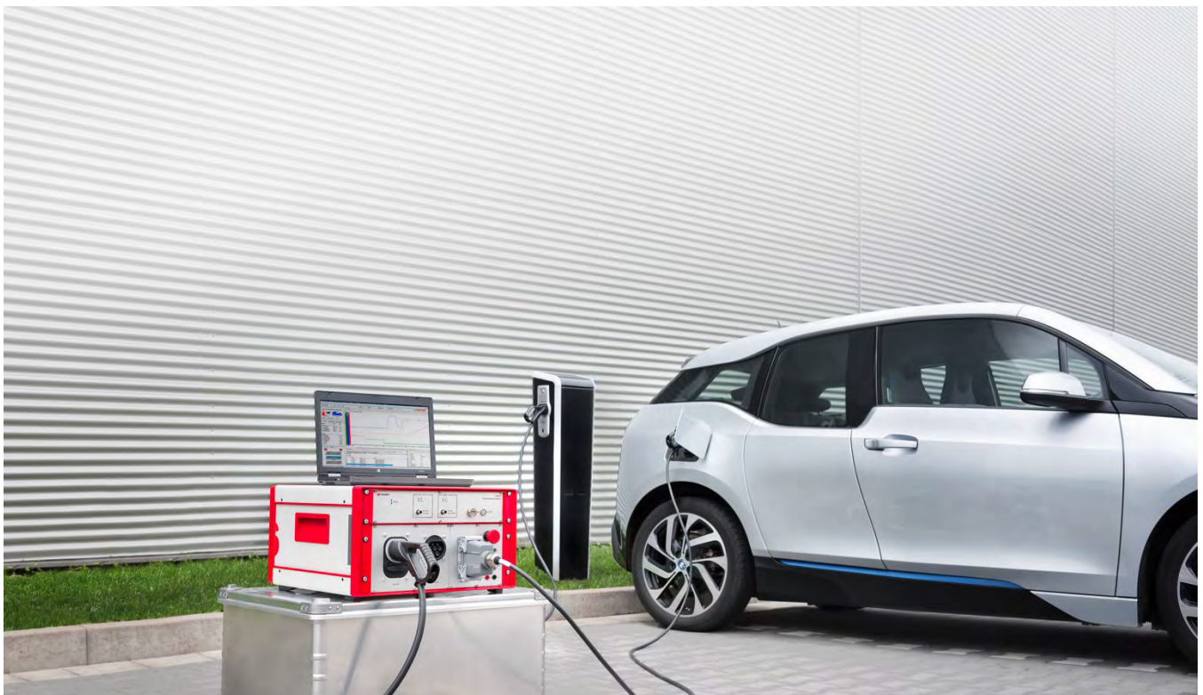
Das Charging Discovery System im Feldeinsatz als Man-in-the-Middle-System
